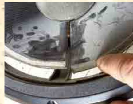
Totalschaden: Nicht nur die Sicke, auch die Membran musste hier getauscht werden
