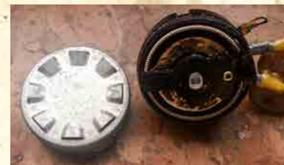
Potenzielle Klangkiller: Drahtpotis, die durch Schalter ersetzt wurden
