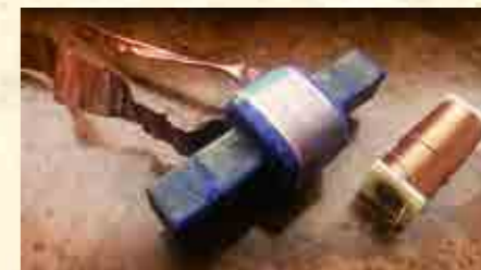
Statt kompakter, billiger Eisenkernspulen setzt Bayer Flachbandspulen mit I-Kern ein
