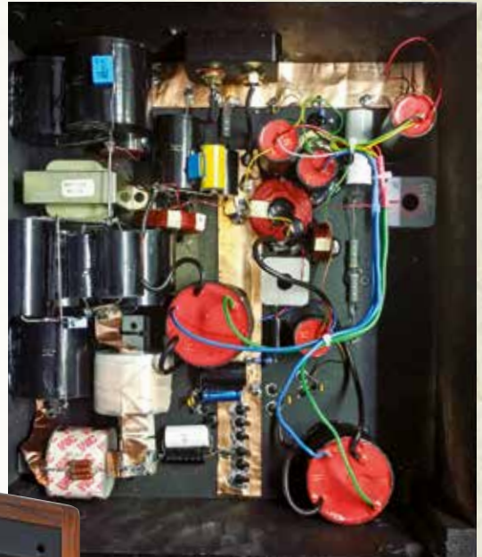
▲ Die Passivweiche, nachdem sie von Bayer komplett neu aufgebaut wurde.
