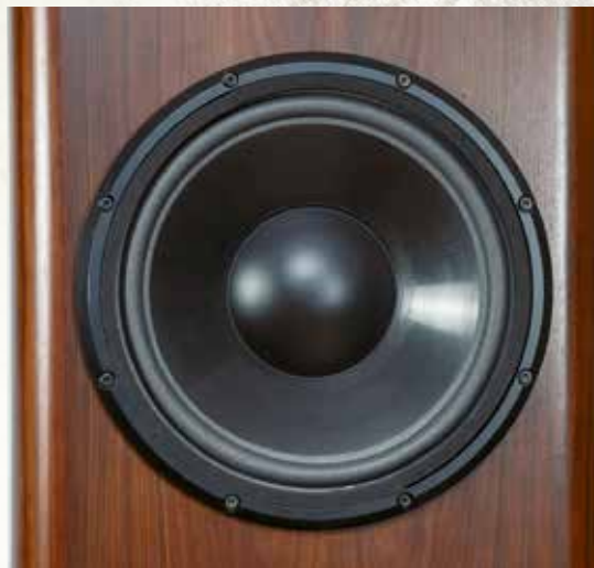
◀ Ein Bass mit neuer Schaumstoff-sicke und steiferer Staubschutzkappe als im Original
