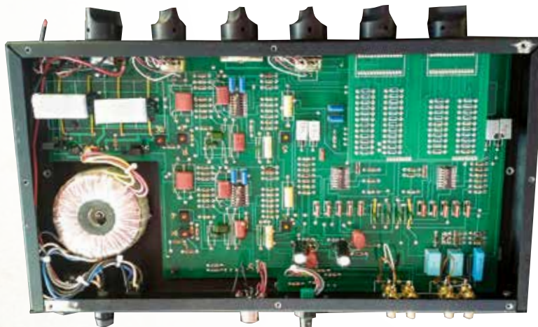
▲ Viele neue, hochwertige Kondensatoren und ICs finden sich nach dem Umbau in der Aktivweiche.
