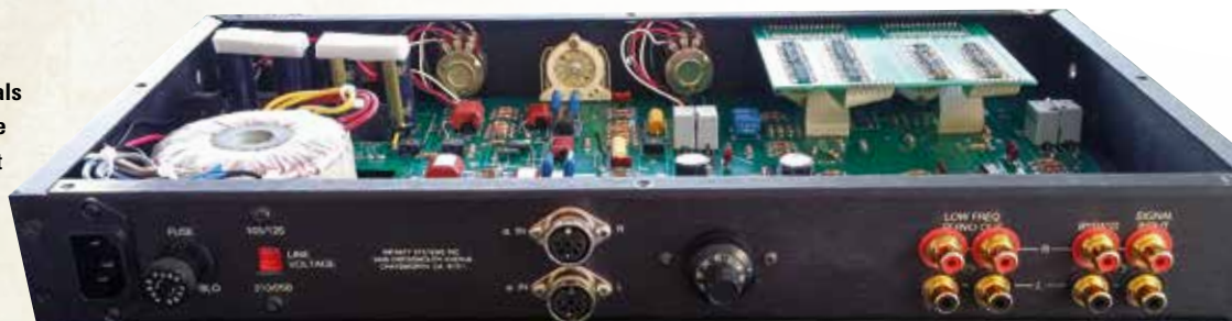
▲ Viele neue, hochwertige Kondensatoren und ICs finden sich nach dem Umbau in der Aktivweiche.
